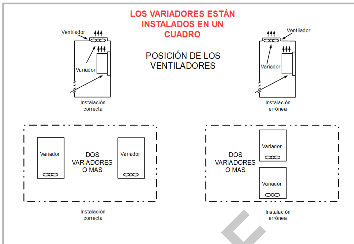
Fig 1.2 Instalación en cuadro eléctrico
