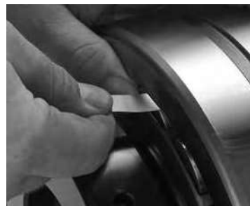
Fig. 18. Medida del RIC antes de la instalación.
