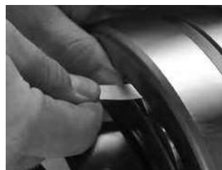
Fig. 14. Medida del RIC antes de la instalación.
