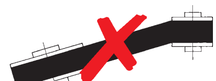
Defecto de alineación horizontal de los ejes
